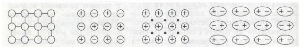
Рис .1. Типи кристалічних ґраток: а — атомні; б — йонні; в — металічні; г — молекулярні
